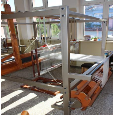
Fotoğraf 16. Çözgünün tezgaha aktarılması
