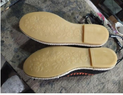
(Foto. 28 Tabanın yapıştırılması.)
