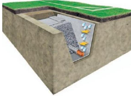
Şekil 6. Jeotekstillerin filtrasyon fonksiyonu (Erdoğan, 2008)
