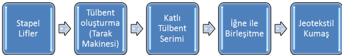
Şekil1. Dokusuz yüzey jeotekstillerin üretim şeması (Erdoğan, 2008)
