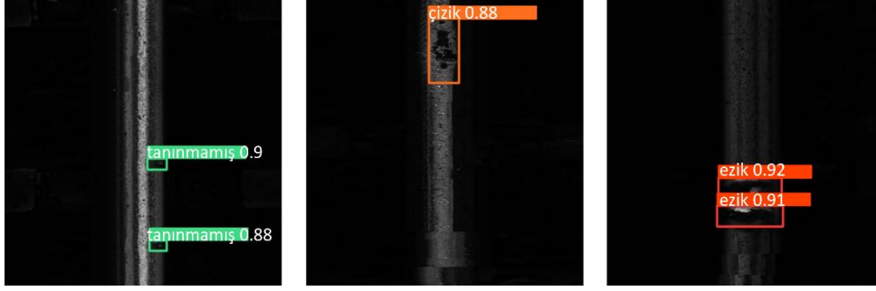
Şekil 19. 416x416 girdi boyutlu YOLOv6s alt mimarisinin test sonuçları
