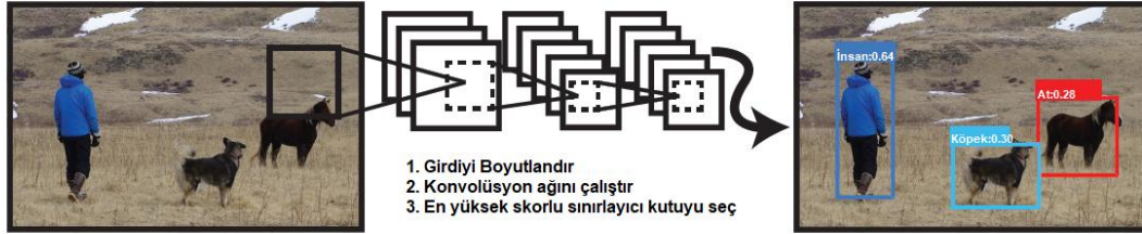
Şekil 4. Nesne tespitinden sorumlu YOLO tespit sistemi [16]
