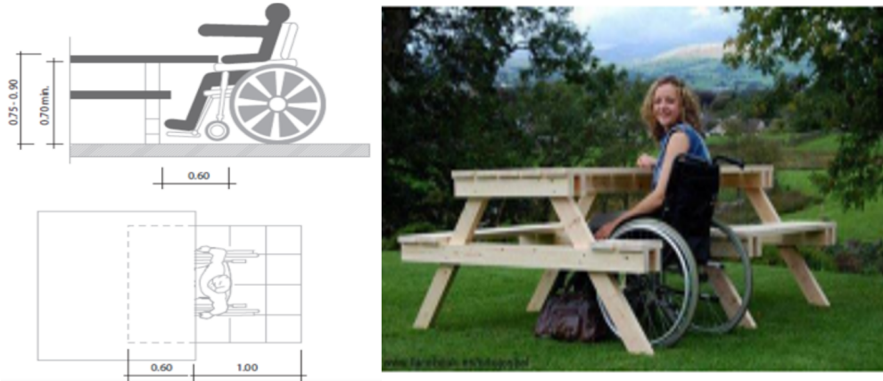
Şekil 9. Tekerlekli sandalyenin masalara yaklaşabilmesi için gerekli olan açıklık
