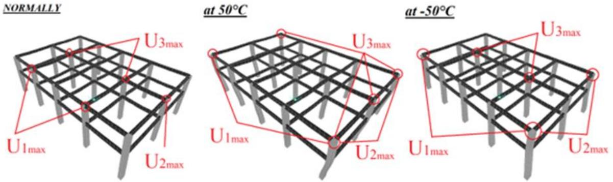
Fig. 7. Columns with maximum displacement ( $U_1$ ,  $U_2$ ,  $U_3$ ).
