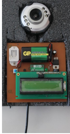
Şekil 2. Çalışma için kameralı elektronik jiroskop (Electronic gyroscope with camera for operation)
