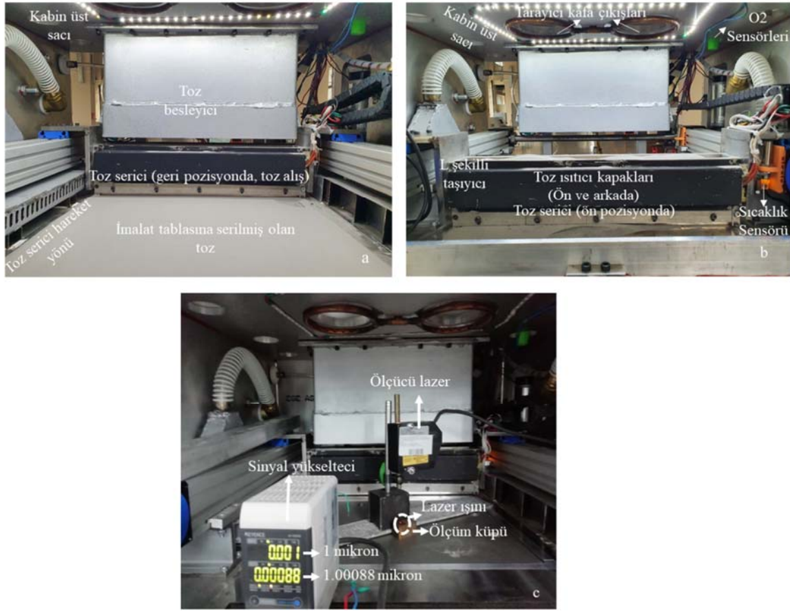
Şekil 3. SLE cihazı imalat alanı a) toz serici sistem geride ve b) toz serici sistem önde c) imalat tablası ve serici kalınlık optimizasyon testi (SLM manufacturing area a) recoater at front b) recoater at back c) thickness test for substrate and recoater)
