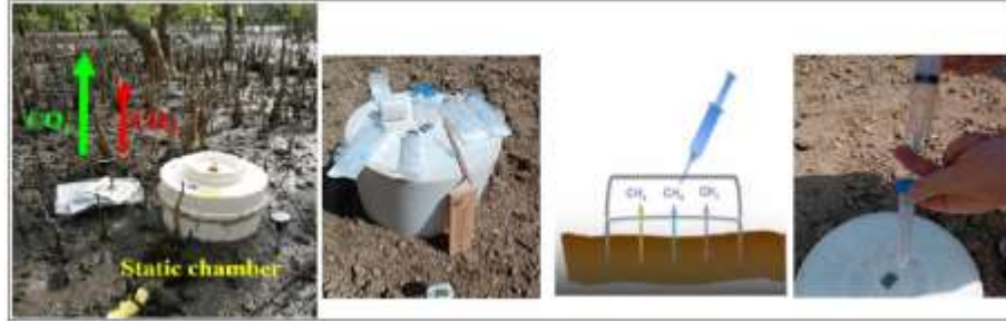
Şekil 5. Toprakta salıverilen ve kova içerisinde biriken CH 4 miktarı 20 ml'lik şırınga ile 0-20-40-60 dakika sonunda çekilerek, cam şişenin içerisine aktarılmış, sonrasında gaz kromatografi yardımıyla analiz edilmiştir
