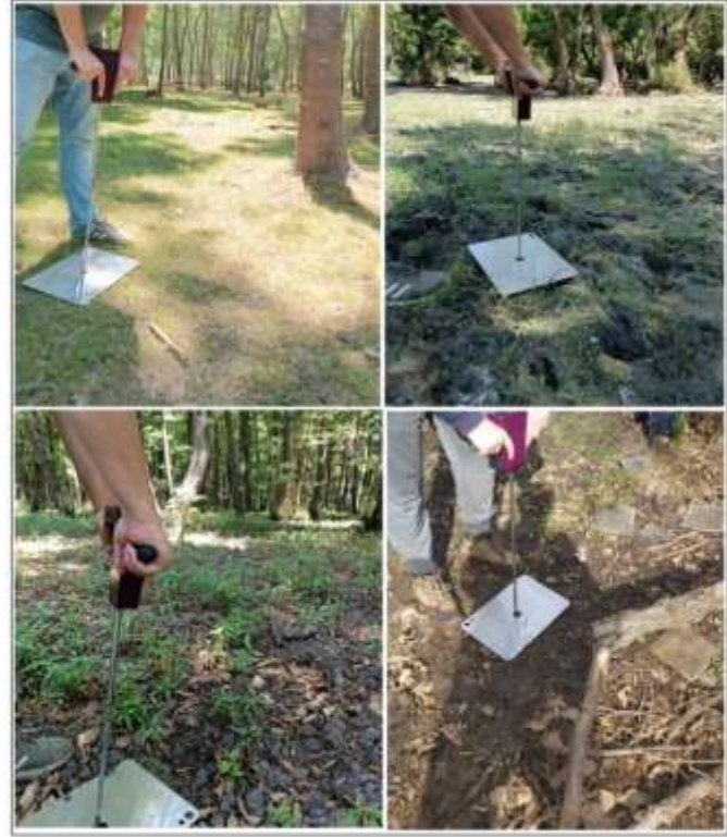
Şekil 2. Toprakların penetrasyon direnci (TPD) arazide, ormancılık faaliyetlerinin yapıldığı dışbudak (üst sol) ve kızılbaş (alt sol) meşcereleri ile doğal dışbudak (üst sağ) ve kızılbaş (alt sağ) meşcerelerinde ölçülmüştür
