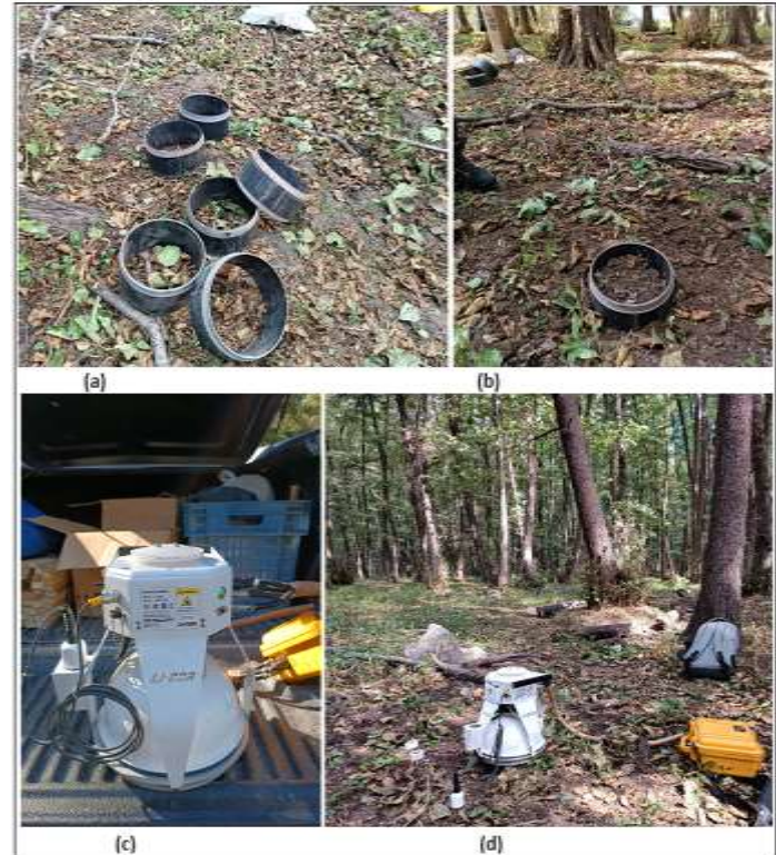
Şekil 4. Toprak CO 2 salınımı örnekleme alanlarında Mayıs ve Eylül ayları ortasında IRGA cihazı (LI-8100A, LI-COR) ile ölçülmüştür
