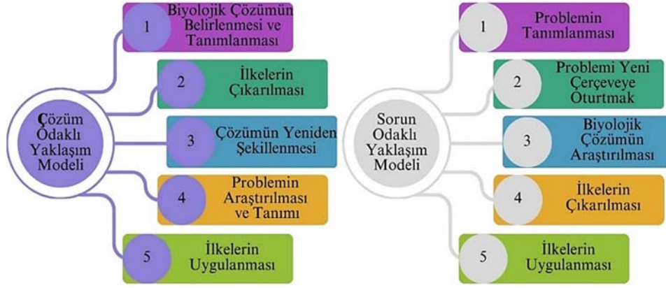
Şekil 1. Çözüm odaklı ve sorun odaklı yaklaşım modellerinde tasarım adımları [50] (Design steps in solution-oriented and problem-oriented approach models [50]).
