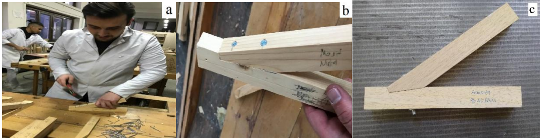
Şekil 3. a) Çivi ile bağlantı işlemi, b) Vida ile bağlantı işlemi, c) Bulon ile bağlantı işlemi Figure 3. a) Nail connection process, b) Screw connection process, c) Bolt connection process
