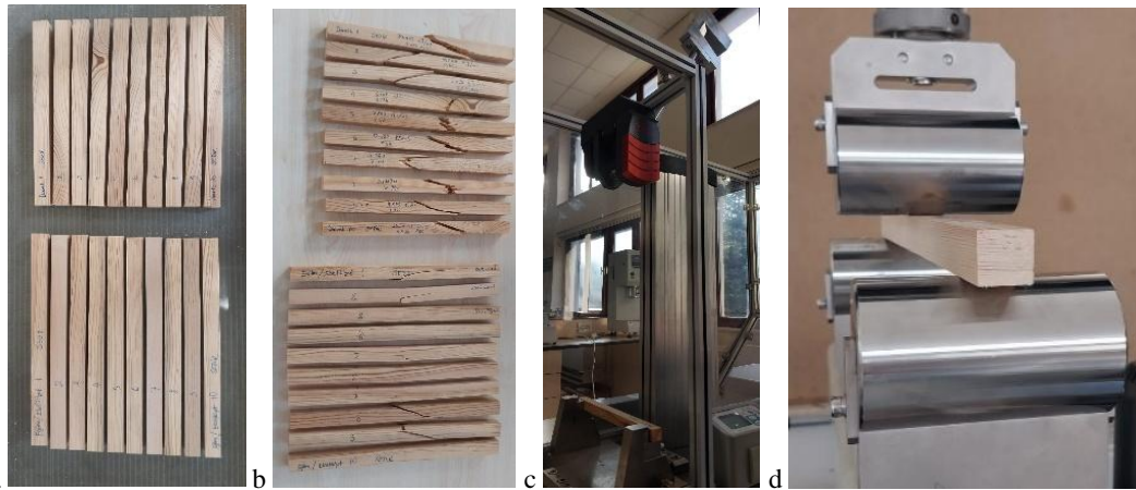
Şekil 4. a) Eğilme direnci, eğilmede elastikiyet modülü ve dinamik eğilme direncine ilişkin deneş öncesi numuneler, b) Eğilme direnci, eğilmede elastikiyet modülü ve dinamik eğilme direncine ilişkin deneş sonrası numuneler, c) Dinamik eğilme direnci deneş düzeneği d) Eğilme ve Eğilmede elastikiyet modülü değerlerinin tespitine ilişkin deneş düzeneği
