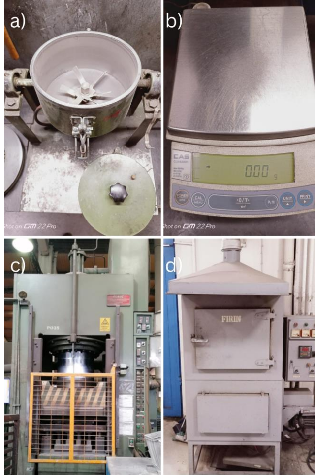
Şekil 1. Disk balataların imalat prosesi a) Laboratuvar tipi mikser b) Laboratuvar tipi hassas terazi c) Sıcak pres d) Fırın
