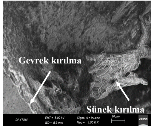
Şekil 10. 50 m/dak kesme hızında kuru ortamda yapılan frezeleme sonrası kesici takımda oluşan kırık bölgenin SEM görüntüsü.
