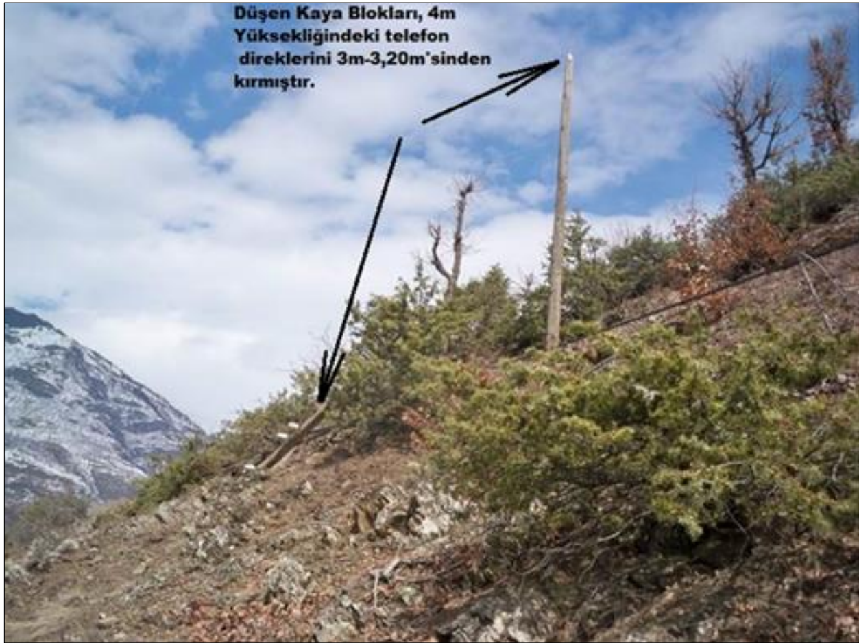
Şekil 16: Kaynak alan alt kotlarında, düşen kaya bloğunun yamaç yüzeyinde (760-750 m kotları) sıçrama yüksekliklerinin 3 metrenin üzerine çıktığı anlaşılmaktadır.
