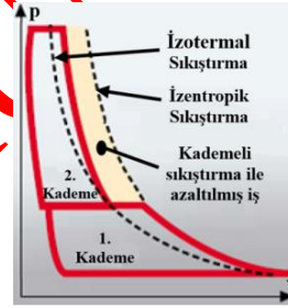
Şekil 1. Kademeli sıkıştırma ile P-V diyagramında kompresör işinin teorik olarak azaltıldığı bölge (The theoretical reduction of the compressor work in the P-V diagram with progressive compression) [44]
