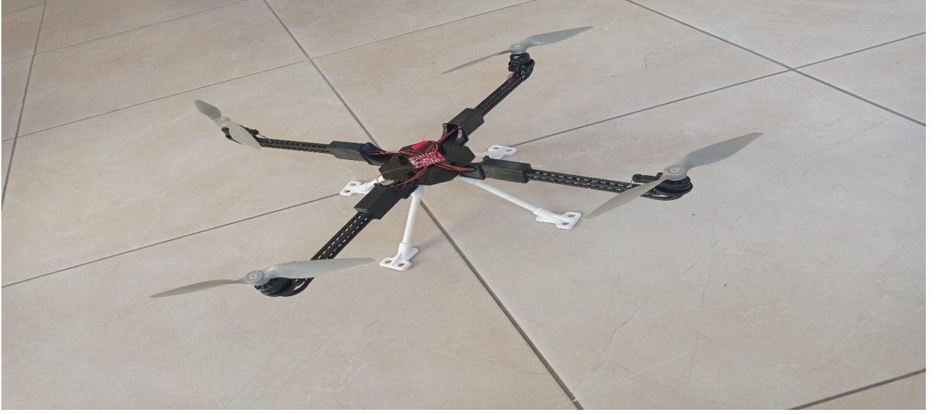
Şekil-9 Üretilen İHA nın gövde üzerine elektronik kart, motor ve kanatların takılması (Installing the electronic card, engine and wings on the body of the produced UAV)
