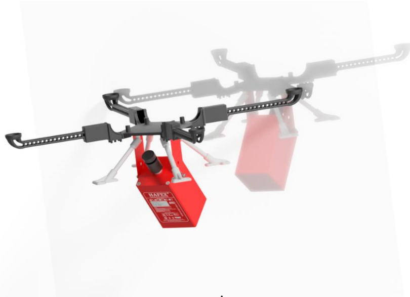
Şekil-3 Tasarımı yapılan yangın söndürme işlemini gerçekleştirecek İHA görseli (Visual of the UAV that will carry out the designed extinguishing process)
