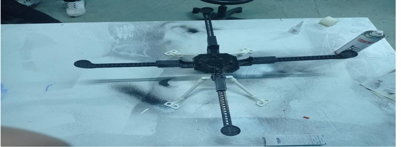
Şekil-8 Üretilen İHA nın kaplama görüntüsü (Coating image of the produced UAV)
