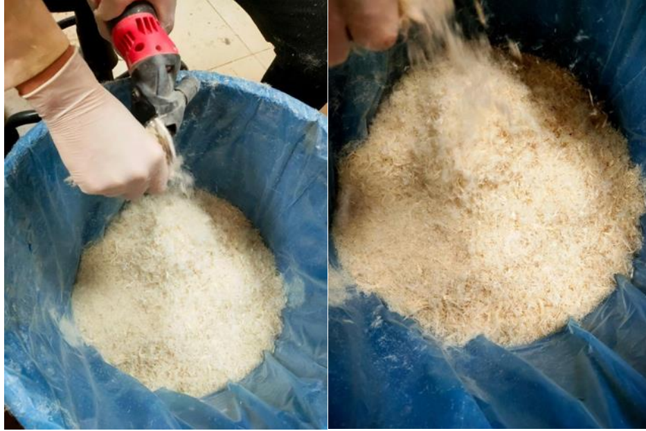
Şekil 1. Tavuk Tüylerinin Kesim İşlemi ve Kullanılan Tavuk Tüyü Görüntüsü
