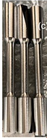
Şekil 3. (a) Kalıp içinde, (b) Kalıp dışında, (c) Talaşlı işlenmiş örnek döküm numuneleri (Figure 3 (a) In the mold, (b) Outside the mold, (c) Machined sample casting specimens)
