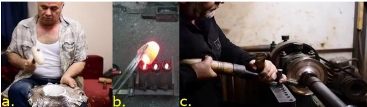
Resim 3: a. Dövü tekniği, b. Kum döküm tekniği, c. Sıvama tekniği
