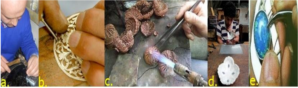
Resim 4: a. Kakma tekniği, b. Kalem tekniği, c. Telkari tekniği d. Ajur tekniği e. Sivama tekniği
