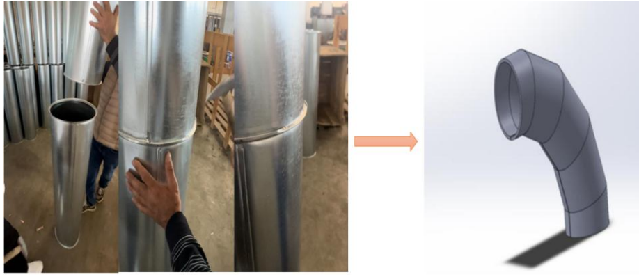
Şekil 4. Birleştirilmiş boru dirseklerinin 6 adet bağlantı elemanları
