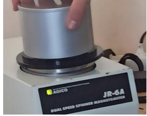
Şekil 7. Spinner manyetometresinde mıknatıslanma şiddeti ölçüm aşamaları
