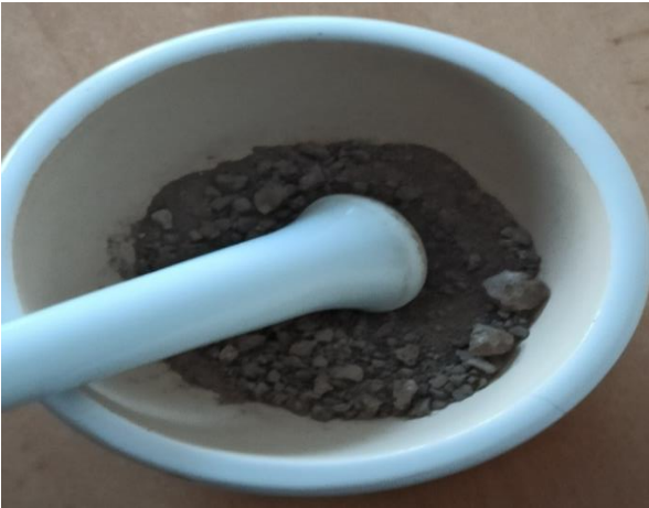
Şekil 5. Numunelerin seramik bir kap içerisinde ezilerek toz haline getirilmesi
