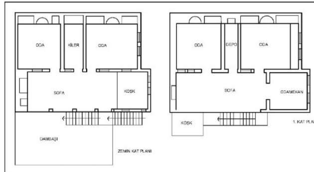
Şekil 6. Bağbeller Evi kat planları (Sayan, 1995 çizimlerinden güncellenmiştir) (Bagbeller House floor plans (updated from Sayan, 1995 drawings))
