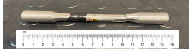
Figure 4. Tensile test sample prepared according to DIN 50125 Standards. Şekil 4. DIN 50125 standartlarına göre hazırlanmış çekme testi numunesi.
