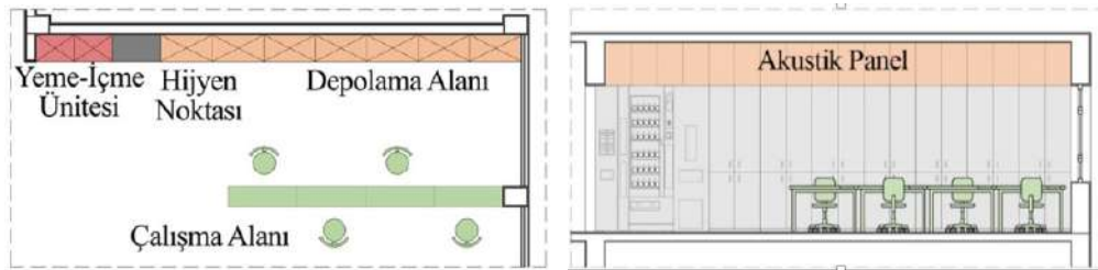
Şekil 4. Atölye fuayeleri için depolama ve çalışma alanı önerisi plan ve kesiti (yazarlar tarafından üretilmiştir).
