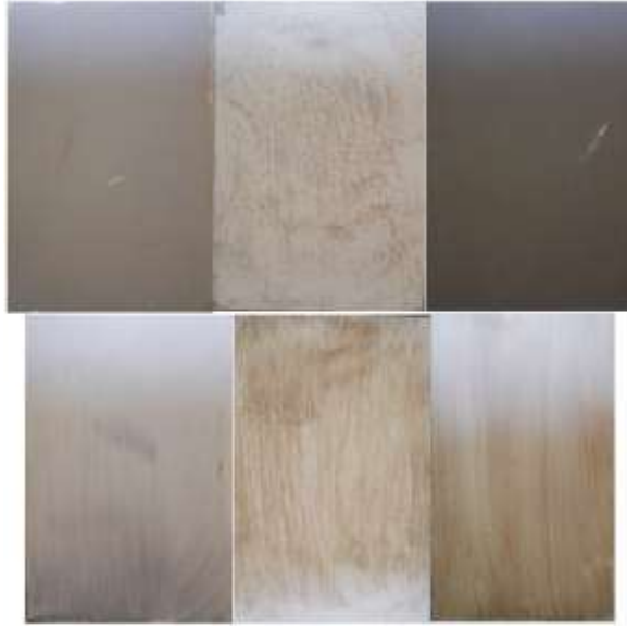
Şekil 4. Galvaniz kaplı olmayan saclara uygulanmış ticari, PE20 ve PE0-C20 boyalar ile boyanmış sacların fotoğrafları (TTB3, TTB2, TTB4 (üst soldan sağa), TTB1, PE20, PE0-C20 (alt soldan sağa))
