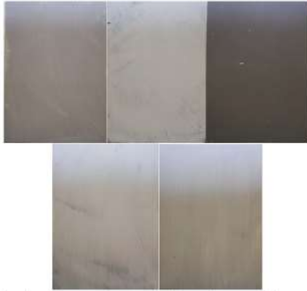
Şekil 5. Galvaniz kaplı saclara uygulanmış ticari ve PE0-C20 boyalar ile boyanmış sacların fotoğrafları (TTB3, TTB2, TTB4 (üst soldan sağa), TTB1, PE0-C20 (alt soldan sağa))
