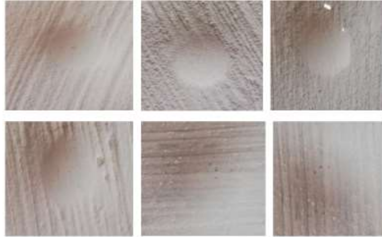
Şekil 8. Galvanizli saca kaplanmış ticari, PE20 ve PE0-C20 boyaların darbe testi görünüşleri (TTB1, TTB3, TTB4 (üst soldan sağa), TTB2, PE20, PE0-C20 (alt soldan sağa))
