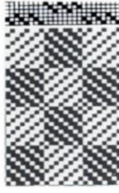
Şekil 5. Blok damask 2/1 ve 1/2 diyagonal dimi Z/S (Cizsuk, 2004: 109)
