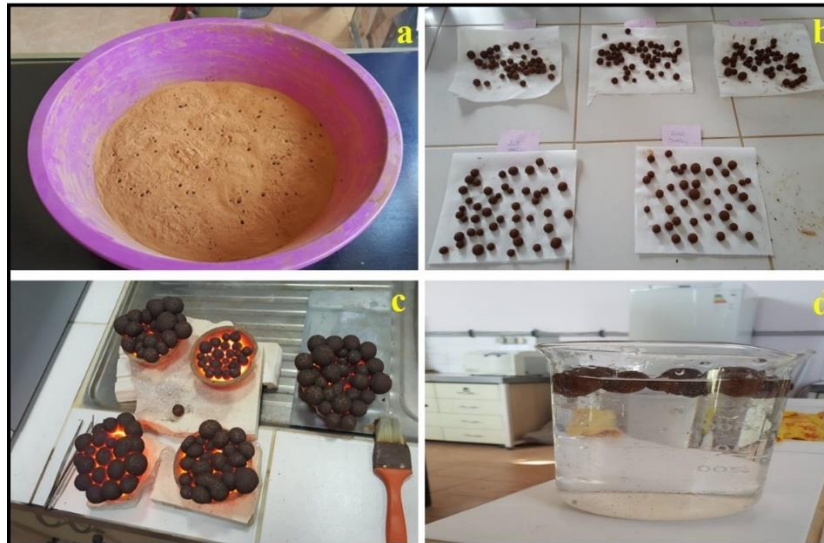
Şekil 2. Almanişınarı killlerinden elde edilen a) macun, b) pellet, c) ısı işleme görmüş pellet ve d) soğutulmuş pelletlerin görünümleri.
