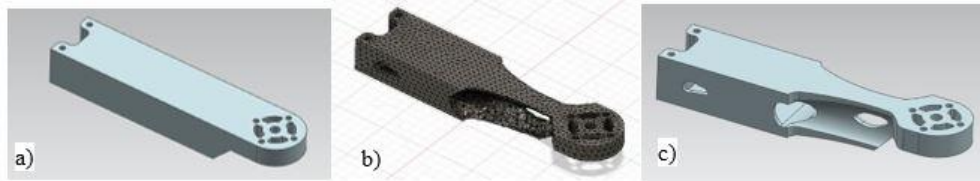
Şekil 4. Dosya dönüşümü a) başlangıç modeli b) optimize edilen model c) CAD dosyasına dönüştürülen model (File conversion a) initial model b) optimized model c) model converted to CAD file)
