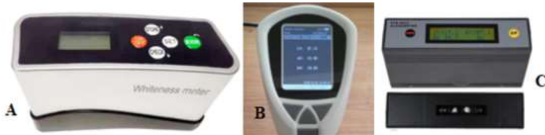
Şekil 1. (A) beyazlık indeksi ölçüm cihazı, (B) renk ölçüm cihazı ve (C) parlaklık ölçüm cihazı
