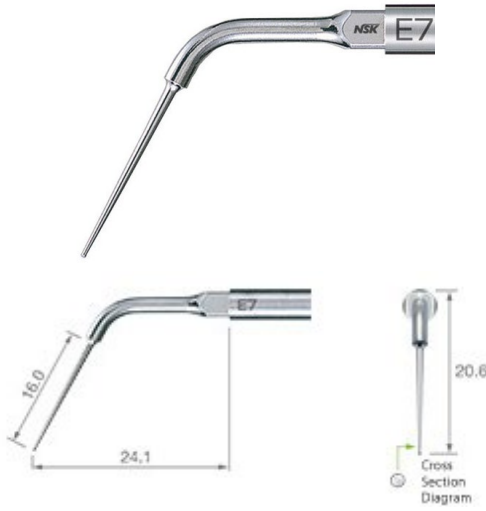
Resim 7. E7 ultrasonik uç (16 mm uzunluk)
