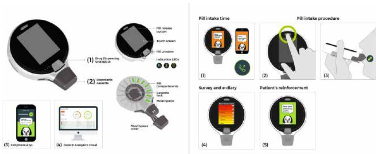
Resim 7. ReX Sistemi Bileşenleri ve Kullanımı (Sht-richman vd., 2018)
