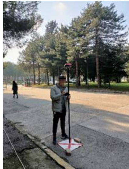
Şekil 6: Yer kontrol noktalarının koordinatlarının ölçülmesi.
