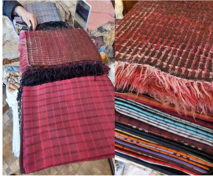
Görsel 2. Dört Çerçeveli Dokuma Tezgahında Dokunmuş İki Farklı İplik Türü Kullanılan Aynı Birim Raporu Uygulanan Dokuma Örneği (Gündüz, 2022).
