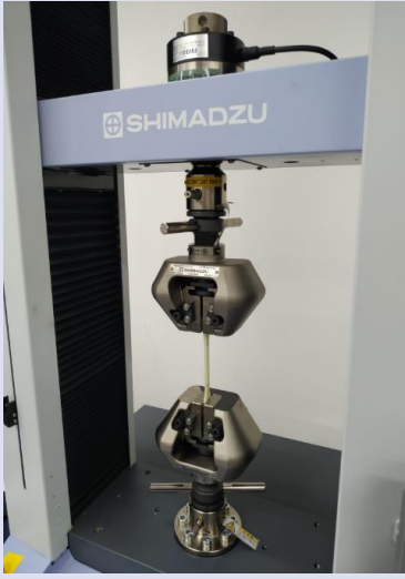
Şekil 9. PETG Numunelere çekme testi uygulaması Figure 9. Tensile test application on PETG specimens
