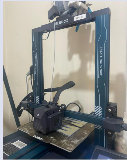
Şekil 7. PETG malzeme kullanılarak FDM yöntemiyle deney numunelerinin imalatı Figure 7. Manufacturing of test specimens using PETG material using the FDM method
