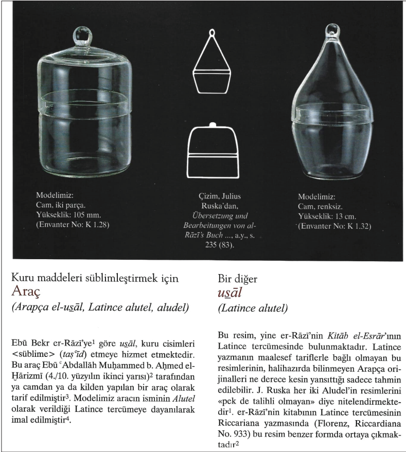
Şekil 1. İslam'da Bilim ve Teknik, Aletler Koleksiyonu Kataloğu kitabında aludel 'in görseli ve tanımı.
