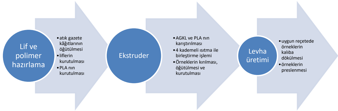
Şekil 1. Lignoselülozik dolgulu termoplastik kompozit levha üretim şeması
