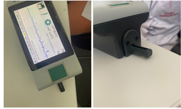
Şekil 1. Yüzey pürüzlülüğü (Ra) ölçümlerinde kullanılan profilometre cihazı (Marsurf PS10, Mahr GmbH, Almanya)
