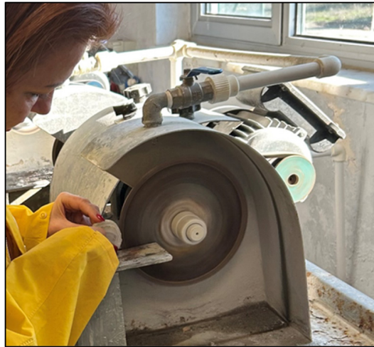
Görsel 2. Elmas Disk İle Süstaşlarından Dilim Alınma İşlemi
