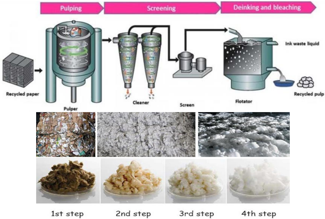
Şekil 3: Atık kağıtların hamurlaştırılmasında mürekkep giderme köpüğü oluşumu ve hamurun kademeli ağartılması ile beyazlığın yükselmesi (CNBM Int., 2023; Karademir, 2023).
