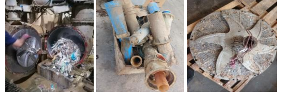
Şekil 11: Üretimde istenmeyen ürünlerin parçalara verdiği zararlardan bazıları.
