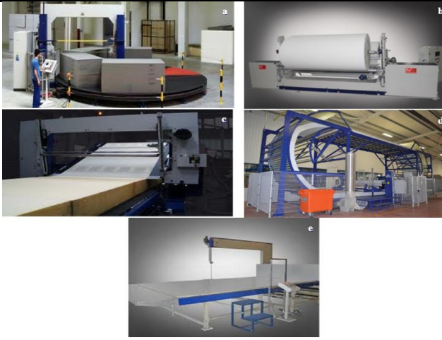
Şekil 6: Köpük kesim makinelerine ait görseller (a: yatay kesim makinesi, b: rulo köpük kesim makinesi, c: tabaka köpük kesim makinesi, d: looper tip köpük kesim makinesi, e: dikey kesim makinesi) (Anonim, 2025h).
