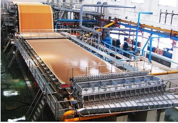
Şekil 12: Fourdrinier kâğıt makinesinde sonsuz elekte formasyon kısmı ve su aynası (XWP Machine, 2023)
